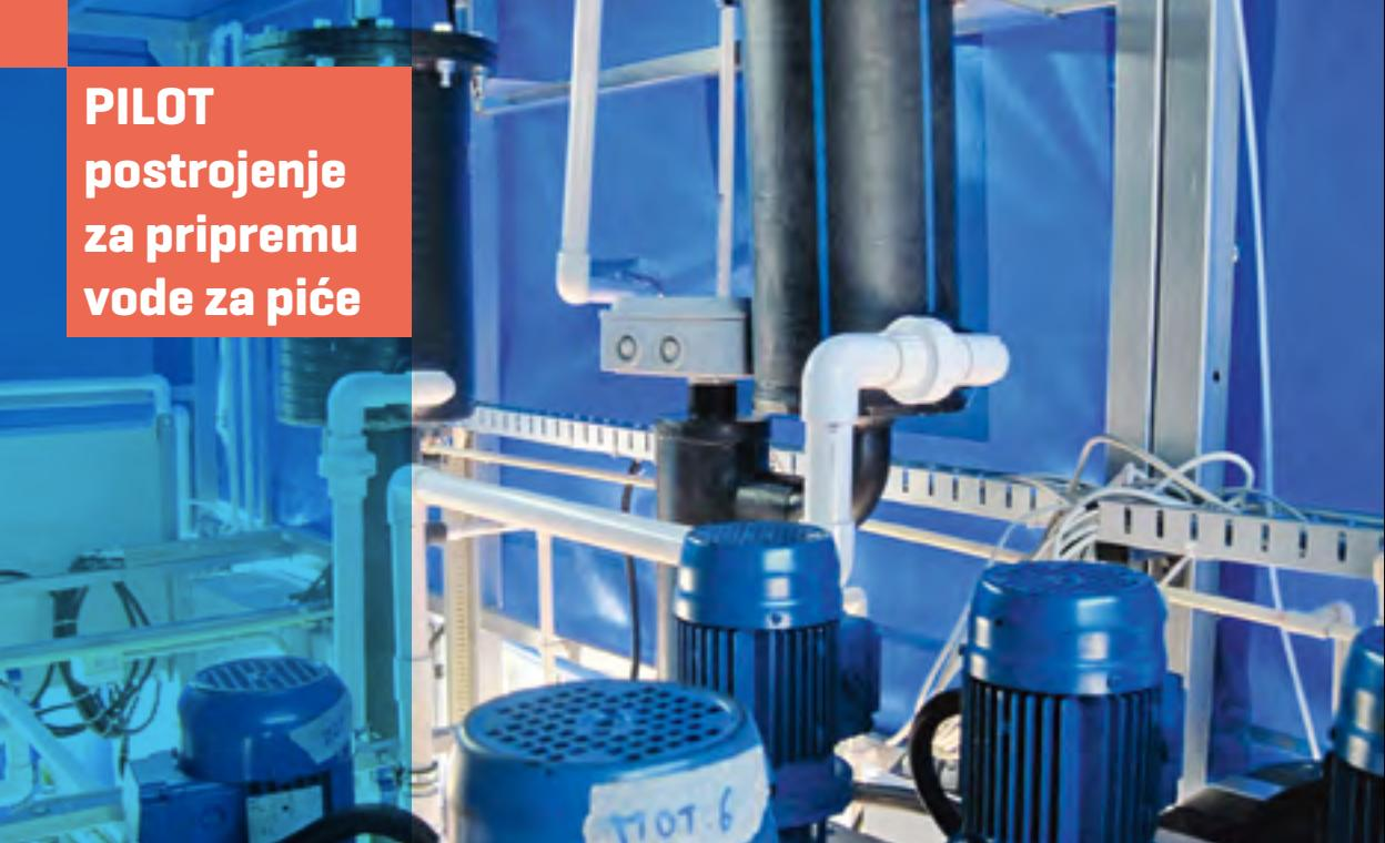
Raspolažemo mobilnim, modularnim PILOT postrojenjem kapaciteta 2 m<sup>3</sup>/h koje se sastoji iz 9 funkcionalnih podsklopova (korekcija pH; oksidacija; koagulacija; flokulacija, taloženje; filtracija; adsorpcija; jonska izmena; membranska separacija). Postrojenje transportujemo na vašu lokaciju i testiranjem na sirovoj i/ili delimično obrađenoj vodi u trajanju 4-6 meseci definišemo tehnološko rešenje.
