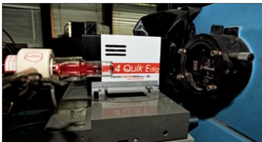
Sistem za spektroskopiju ICCD kamera i monohromator
