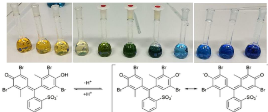
Слика 9.11. Распон боја индикатора у зависности од рН вредности раствора. Протонована и депротонована форма индикатора.
