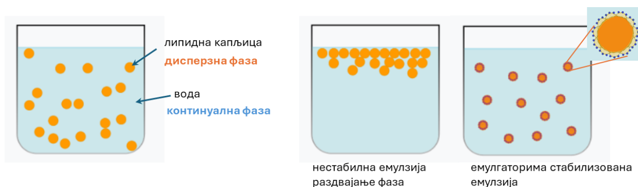
Слика 2.7. Шематски приказ две фазе код емулзија, као и утицаја емулгатора на стабилизацију дисперзног система
