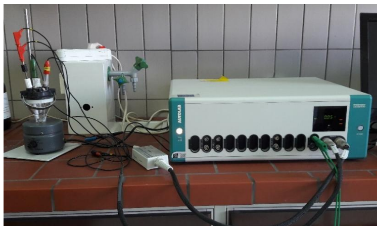
Слика 6.4. Волтаметријски уређај Autolab PGSTAT 12 са рачунаром и волтаметријском ћелијом
