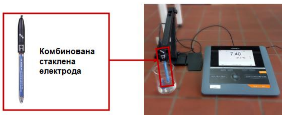
Слика 6.3. Лабораторијски рН метар са комбинованом стакленом електродом
