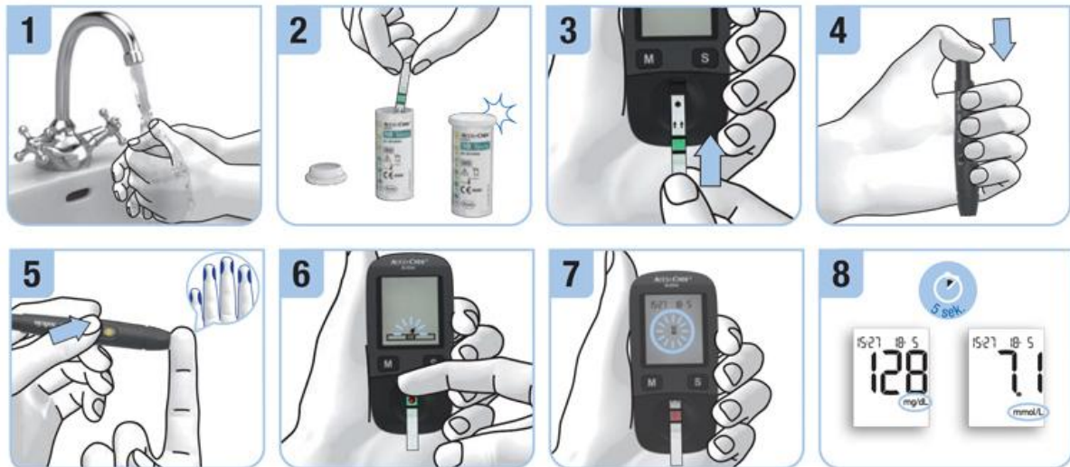
Слика 2.3. Поступак мерења глукозе у крви помоћу Accu-Chek Active апарата
