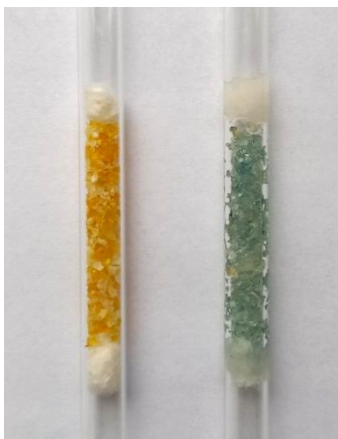
Слика 4.4. Изглед „Алкотеста“ пре и након доспећа етанола у цевчицу
