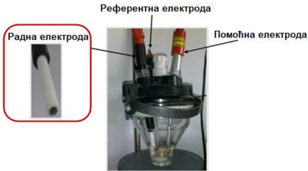
Слика 7.2. Волтаметријска ћелија са троелектродним системом
